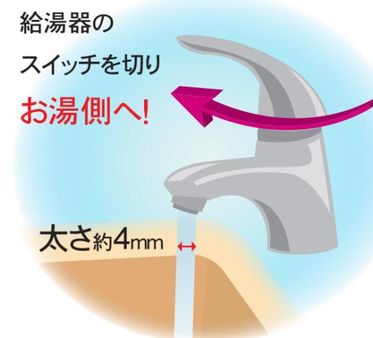
水道管の中を水が動いている場合は凍結する可能性が減ります。就寝前に給湯器のリモコンの運転スイッチを切り、蛇口をお湯側に動かし、少量の水(1分間で400cc程度)を流し続けてください。浴槽で受ければ、後で使えて経済的です。
